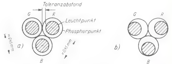
Bild 5. a) Leuchtunktgröße (schraffierte kleine Kreisflächen) innerhalb des zugehörigen Phosphorpunktes (große Kreise) und Toleranzabstand; b) Vergrößerung des Leuchtunkt-Abstandes durch Ablenkfehler bis zur Toleranzgrenze
