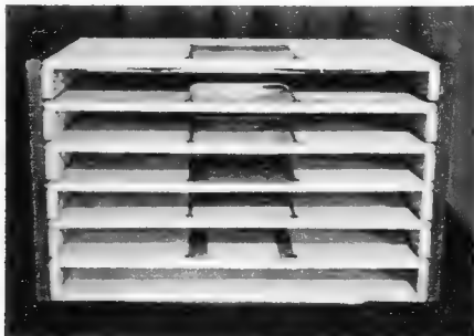
Bild 1. Frontansicht der Spulenträgerbox zum Aufbewahren angefangener Tonbänder
